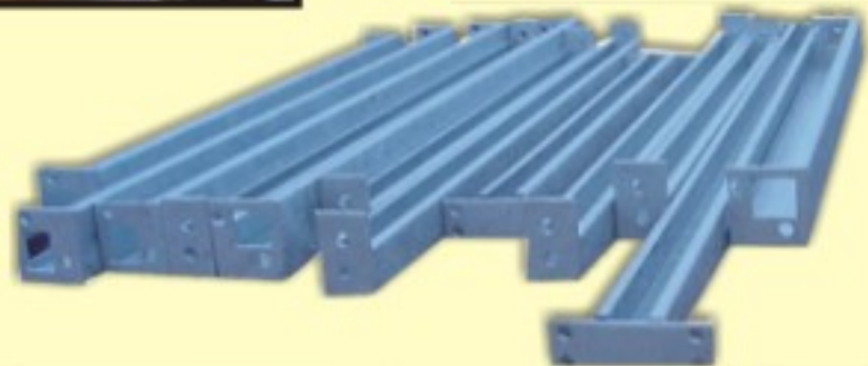
Stahlbauvorfertigung für anschließende Feuerverzinkung bzw. Korrosionsschutzbeschichtung
