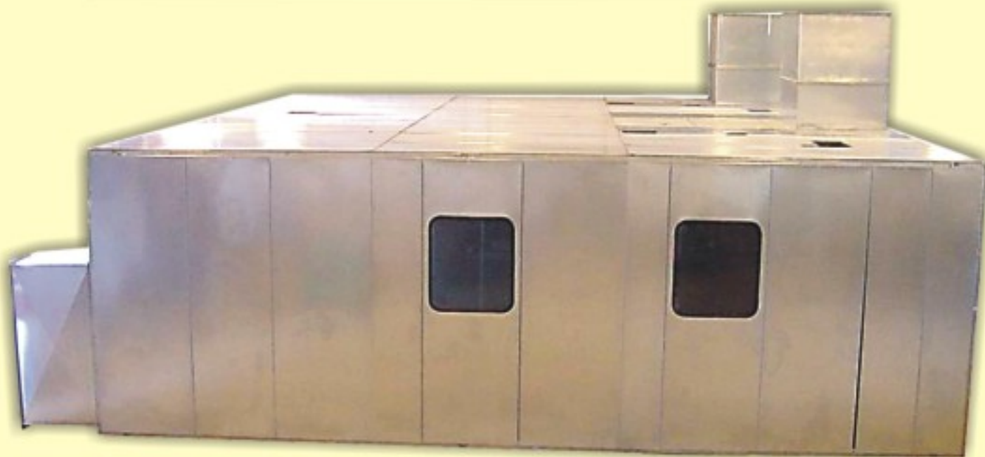
Schallschutzkabine mit Tragkonstruktion, Zu.- und Abluftschalldämpfer mit Teilverglasung der Wandelemente
