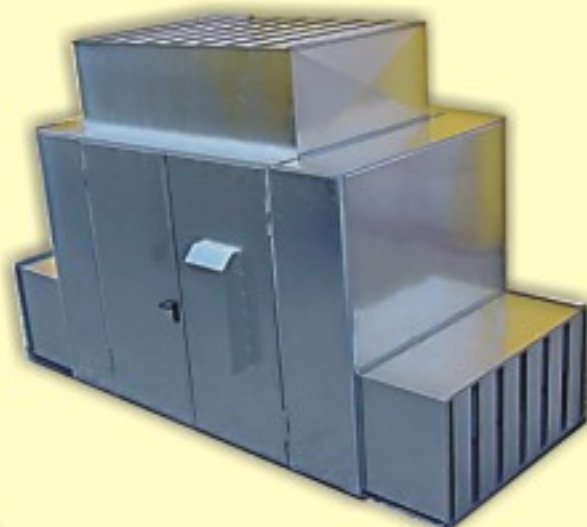
Schallschutzkabine mit Tragkonstruktion aus 80 x 3,0mm Vierkantrrohr mit Zu- und Abluftschalldämpfer
